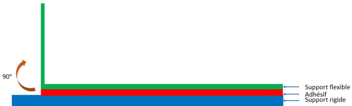
Figure 4 : Schéma de principe du pelage à 90°
