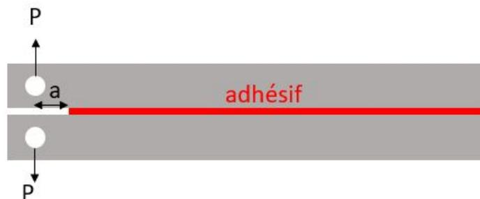
Le chargement  $P$  et le déplacement  $\delta$  sont enregistrés pour chaque longueur de fissure  $a$ . Il existe ensuite plusieurs méthodes d'analyse des résultats permettant d'extraire l'énergie de rupture. La plus simple est la théorie de la poutre simple (SBT) où l'hypothèse faite est la suivante: chaque substrat est considéré comme une poutre en flexion simple et la partie non collée est supposée être encastree au point de départ de la fissure.
